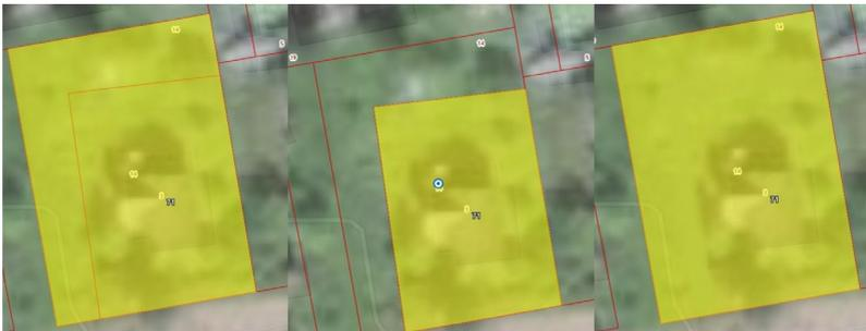
Рис. 2. Пример исправления реестровой ошибки с использованием технологии автоматизированного дешифрирования аэрофотоснимков
