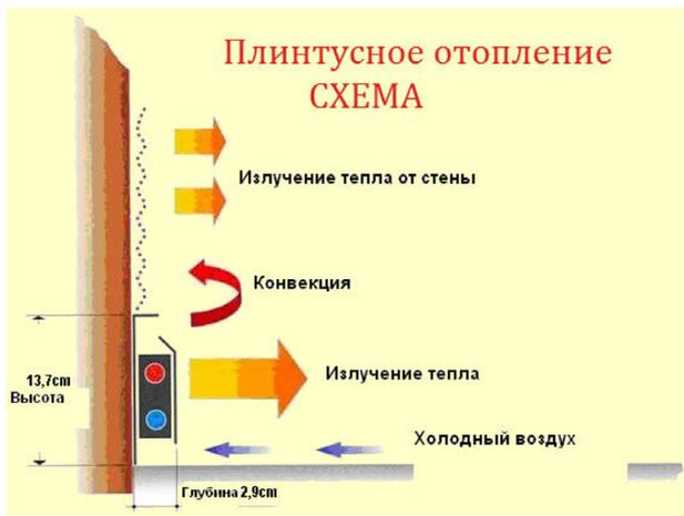
Рис. 2. Принципиальная схема работы систем плинтусного отопления
