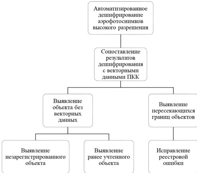
Рис. 1. Принципиальная схема разрабатываемых алгоритмов ПКК по выявлению неучтенных и ранее учтенных объектов, а также реестровых ошибок
